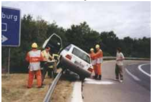
↑ Leitplanke als Auffahrrampe "missbraucht"
